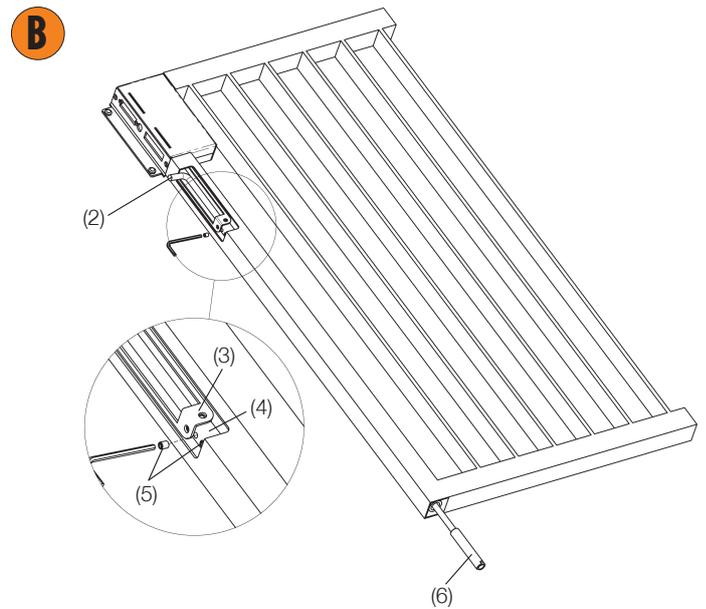
Griffteil (2) in Halterung (3) montieren und mit Kupplungsstück (4) verschrauben. Mit Gewindestift (5) sichern. In Rohrprofil einsetzen. Gewindestange (bauseits) mit Kupplungsstück (4) verschrauben und mit Gewindestift (5) sichern. Riegel (6) montieren.
