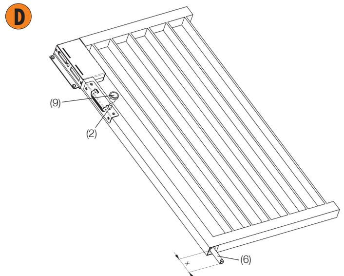
Knopf (9) auf Griffteil (2) schrauben und mit Gewindestift sichern. Riegel (6) justieren und mit vormontiertem Gewindestift sichern. Riegelschutzkappe auf Riegel aufsetzen.
