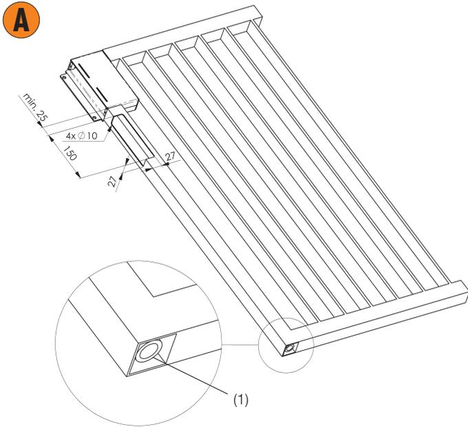
Ausschnitt mit Hilfe der Schablone in Rohrprofil einbringen. Riegelführung (1) für Riegel in gleiche Ecke wie Ausschnitt einschweißen. Abstand des Tores zum Boden beachten. (Riegelausschluß 80mm!)
