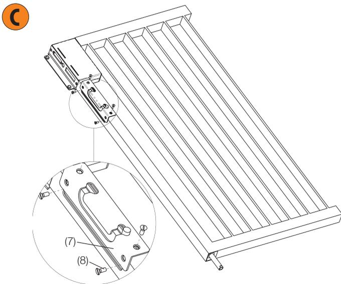
Führungskulisse (7) aufsetzen und mit Senkschrauben (8) an Halterung (3) befestigen.
