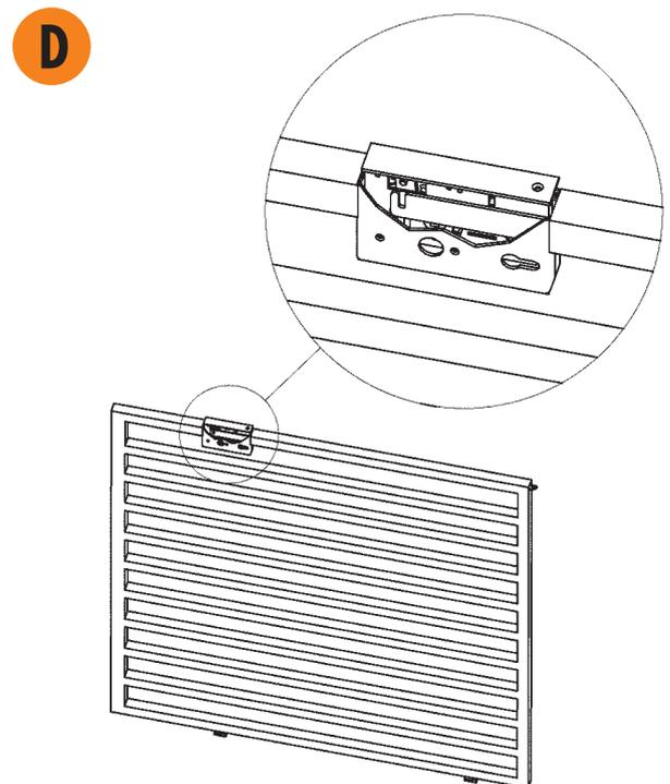
Adapterstücke zum Schloss positionieren, das Schloss komplett einsetzen und Fallenbolzen justieren.
