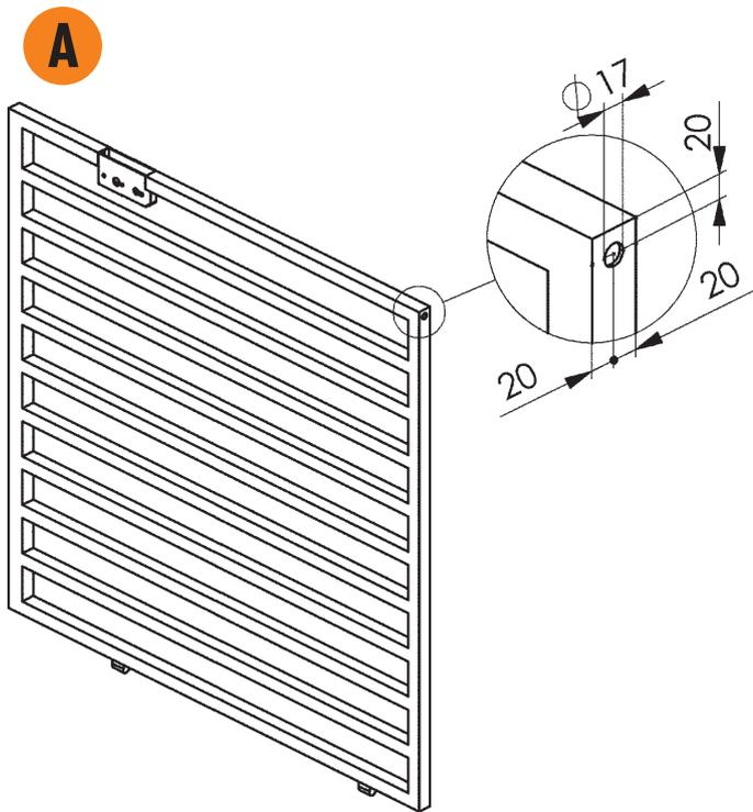
Schlosskasten bündig in den Rahmen einschweißen. Rahmenbohrungen unten  $\varnothing$  17 mm setzen.
