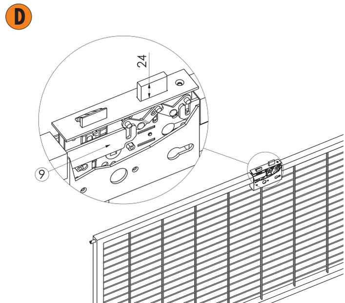
Adapterstücke zum Schloss positionieren (9), das Schloss komplett einsetzen und Riegelbolzen justieren.
