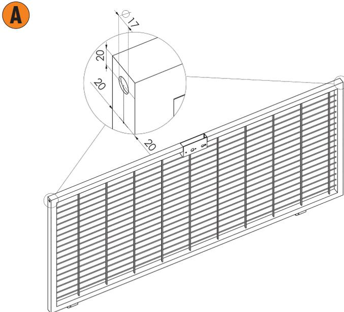
Schlosskasten bündig in den Rahmen einschweißen. Rahmenbohrungen oben und unten Ø 17 mm setzen.
