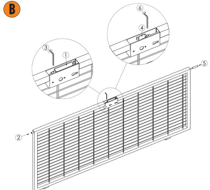
Gewindestange (bauseits) und Riegelbolzen (Lieferumfang) miteinander verbinden (2), (5). Gewindestange an Adapterstücke (1), (4) im leeren Schlosskasten anschrauben (3), (6).
